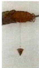
Cuerda de nylon calibrada a cada 20mts y plomada de metal utilizada para medir la profundidad en cada perforación
